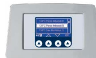
Grazie al **display LCD** di facile lettura e all'intuitiva tastiera integrata, l'operatore può controllare e pilotare la sterilizzatrice in tutta serenità. L'identificazione univoca degli operatori in relazione al ciclo eseguito avviene mediante **codice PIN**.
